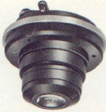
MS 65 zweilinsiger Kondensator (für Hellfeld, Dunkelfeld, Phasenkontrast und Anoptralkontrast).
