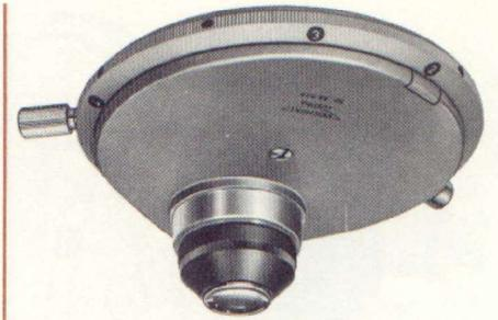
Kontrastkondensator mit langer Schnittweite (für Hellfeld, Dunkelfeld, Phasenkontrast und Anoptralkontrast).
