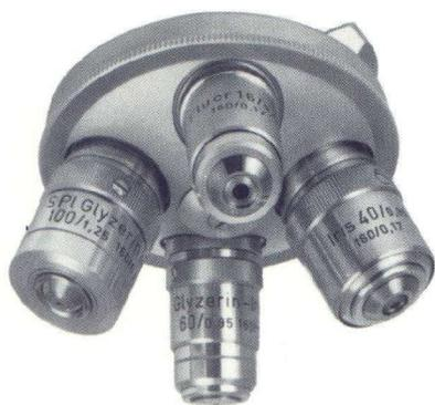
**Objektivrevolver 4X** mit Sonderobjektiven für die Fluoreszenzmikroskopie. Diese besitzen hohe Aperturen, sind sehr gut durchlässig für kurzwelliges Licht und ohne jede Eigenfluoreszenz. Überstrahlungen bei dicken Objekten können durch die eingebauten Irisblenden unterdrückt werden. Die Immersionsobjektive sind für Glycerin ausgelegt, das einfach zu manipulieren, völlig fluoreszenzfrei, wasserlöslich und mit organischen Substanzen meist gut verträglich ist.
